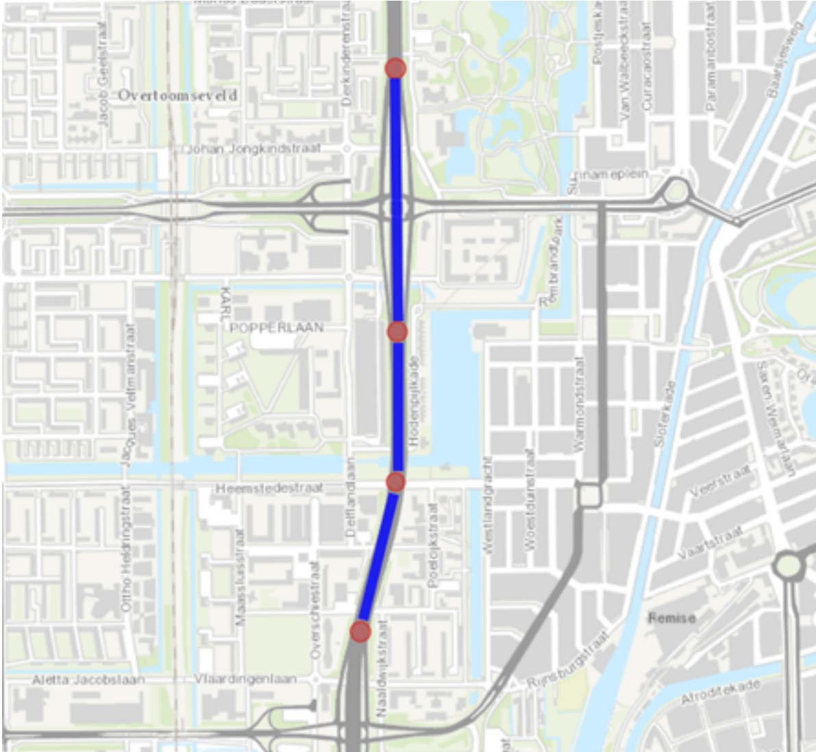
Figuur 62: De blauwe lijn is de weg of wegvak; dit is 1 line string. De weg is bij het tekenen opgedeeld in afzonderlijke segmenten, welke in de figuur begrensd worden door de rode bollen. SRM2 ziet elk wegsegment apart
