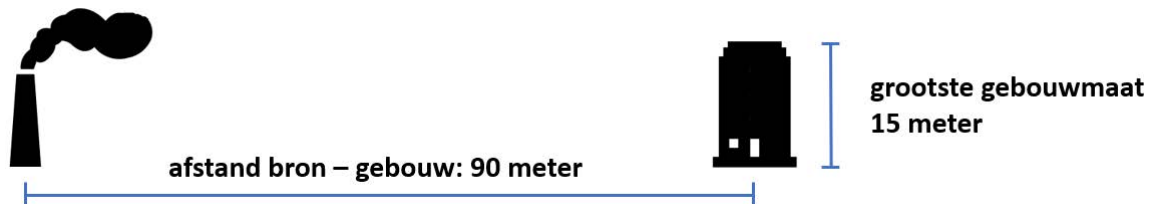
Figuur 4.4 De afstand tussen bron (losstaande schoorsteen) en gebouw is hier 6 maal de grootste gebouwmaat; gebouwinvloed moet hier in principe meegenomen worden.
